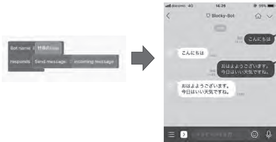
図 9 送信したメッセージをおうむ返すブロックの組み合わせと動作例
