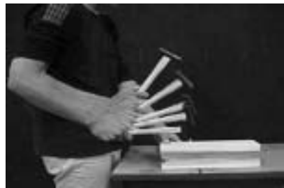
図11 玄能を振り上げて手首の回転を使って打つ打ち方
