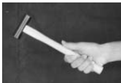
図 8 手の平側から見た玄能の握り方
