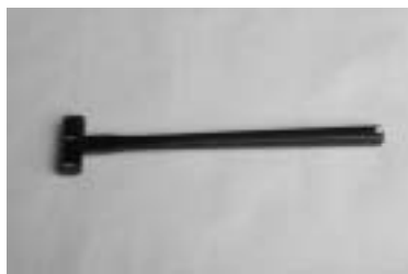
図 1 実験に使用した 185g 玄能
