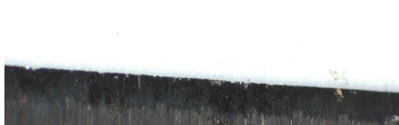
図 52 鉋 C 100 回切削後
