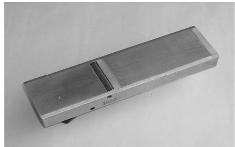
図6 鉋台下端面の調整
