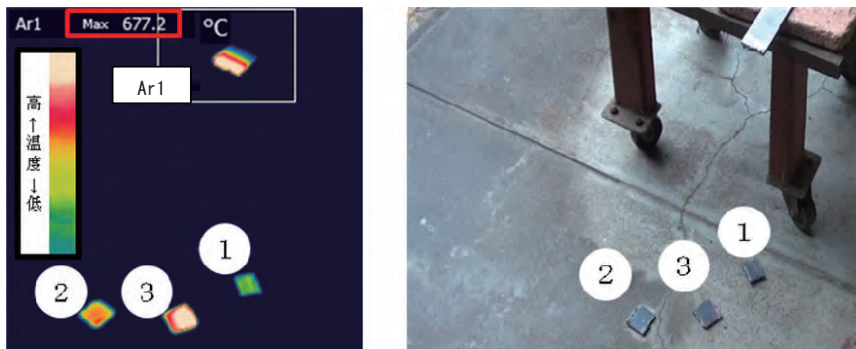
図 6a. ガス溶断機による溶断直後の温度変化
