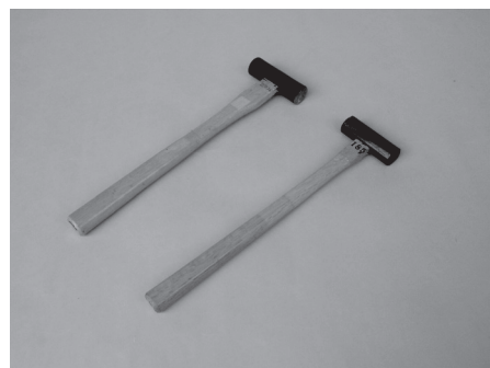
図2 実験に用意した230g玄能(左)と185g玄能(右)
